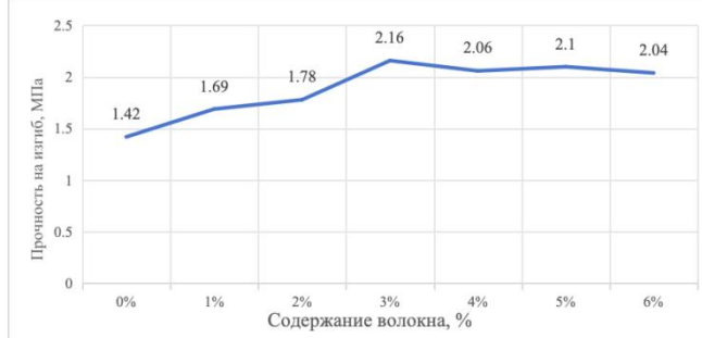
Рисунок 3 – Прочность на изгиб пенобетона с различным содержанием тростникового волокна
